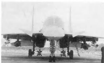
Главная особенность Су-27ИБ - двухместная кабина с размещением пилотов бок о бок
