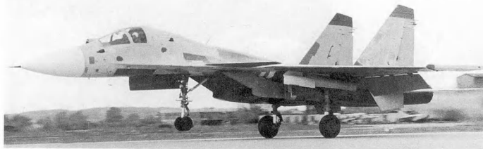
Внешне учебно-боевой корабельный Су-27КУБ отличается только двухместной кабиной по образцу Су-32, но реально Су-27КУБ несколько больше по размерам. Фактически это уже другой самолет!
