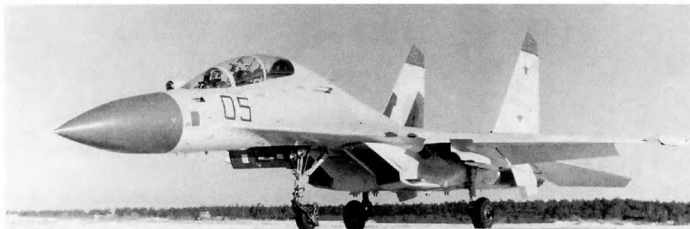
Су-30 создан на базе учебно-боевого Су-27УБ и внешне отличается только выдвинутой штангой системы дозаправки топливом в полете (на этом фото видно ее гнездо слева перед кабиной)
