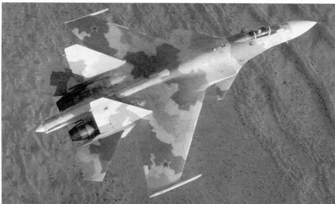
Модернизированный Су-27М (или Су-35) получил дополнительное переднее горизонтальное оперение
