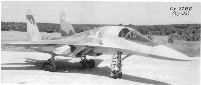
Главная особенность Су-27ИБ - двухместная кабина с размещением пилотов бок о бок
